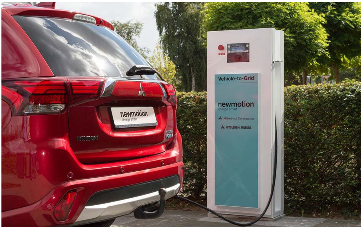
Двонаправлений зарядний пристрій V2G та Mitsubishi Outlander PHEV © mitsubishi-motors.com
