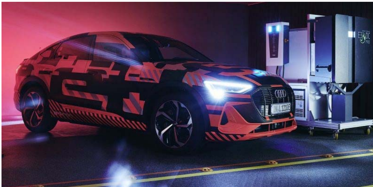
Стенд Audi з тестування двонаправленої зарядної мережі © volkswagenag.com
